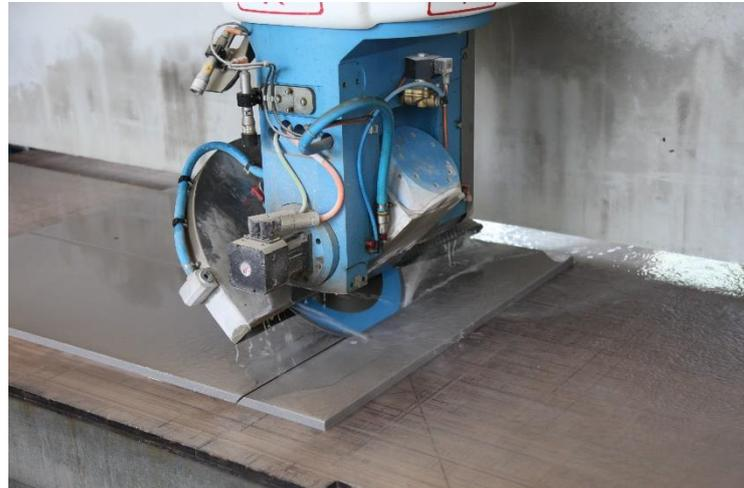
*Abbildung 2: Auf den Millimeter genau: Selbst härteste Stein-sorten werden von computergesteuerten Maschinen sicher und exakt zugeschnitten.*
